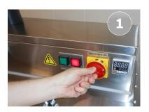
Mettre le sélectionneur sur I et tourner l'interrupteur sur **ON**
