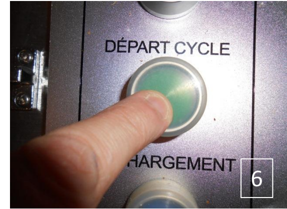
Appuyer sur DEPART CYCLE , les voyants verts s'allument. La machine démarre. Ne pas ouvrir la trappe de chargement pendant le cycle. En fin de cycle la machine s'arrête automatiquement.
