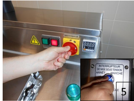
Mettre le sectionneur sur I (on). Puis tourner l'interrupteur sur MARCHÉ . Puis Mettre l'interrupteur sous tension
