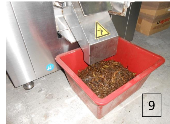
La machine se vide pendant 20 minutes. Mettre l'interrupteur sur ARRÊT et le sectionneur sur O (off). Nettoyer les surfaces et les joints de portes avec de l'eau savonneuse
