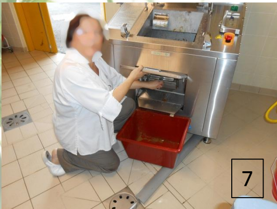
Pour décharger, mettre un bac devant la trappe de déchargement Déverrouiller et ouvrir la trappe de déchargement
